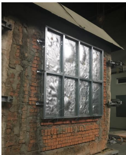
Рисунок 5 – Фрагмент конструкции с заполнением материалом образца
